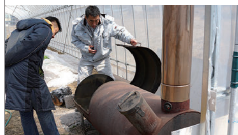
燃料は松枯れ材。円柱型無煙炭焼き機を薪ストーブ代わりに、冬のビニールハウスを加熱。
